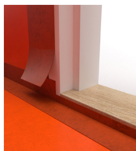
BILD E - Tröskel i liv med vägg Försegling ska utföras kontinuerligt mellan tröskel, karm och vägg.
